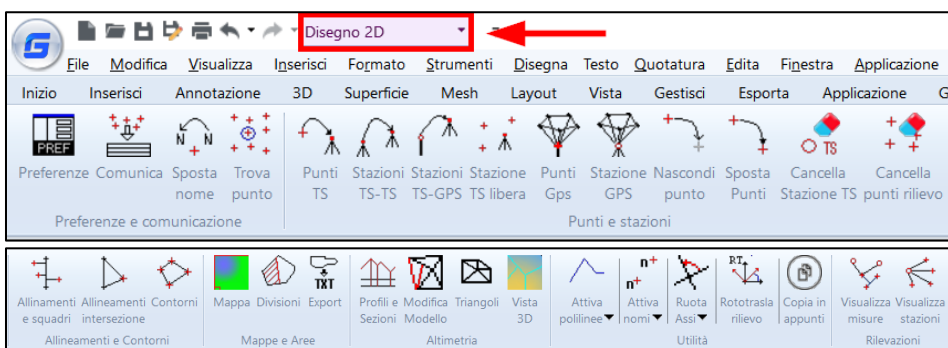
Figura 191 – Per i comandi del CAD è possibile attivare il mix tra i menù tradizionali e le toolbar, con questa modalità i comandi dell'applicativo Geocat sono facilmente accessibili da una comoda toolbar che ne rende intuitiva e veloce l'applicazione.
